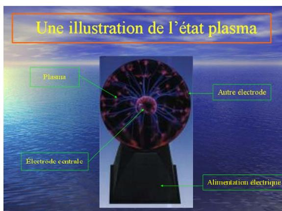
**Manon** : « ... Lorsque l'on met la tension sur l'électrode centrale, cela émet des électrons qui forment un chemin pour les autres électrons qui vont suivre. Lorsque l'on pose la main sur la boule à plasma, on s'aperçoit que le courant se dirige vers la main qui est un chemin plus facile. Lorsque l'on pose un néon sur la boule à plasma, celui-ci s'allume, ce qui prouve que le courant passe pour parvenir à la main qui le tient... Cela excite les électrons qui provoquent la lumière du néon... »
