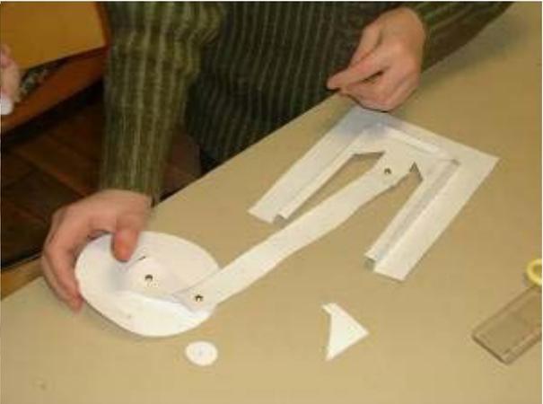
Construction par groupes de deux d'un système piston – bielle – manivelle
