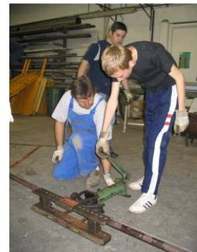
Peu à peu, le **châssis** se monte...les faces sont assemblées par des **traverses**, les élèves **pointent à l'arc** les assemblages aidés des employés de l'atelier qui reprendront ensuite toutes **les soudures** pour une sécurité optimale.
