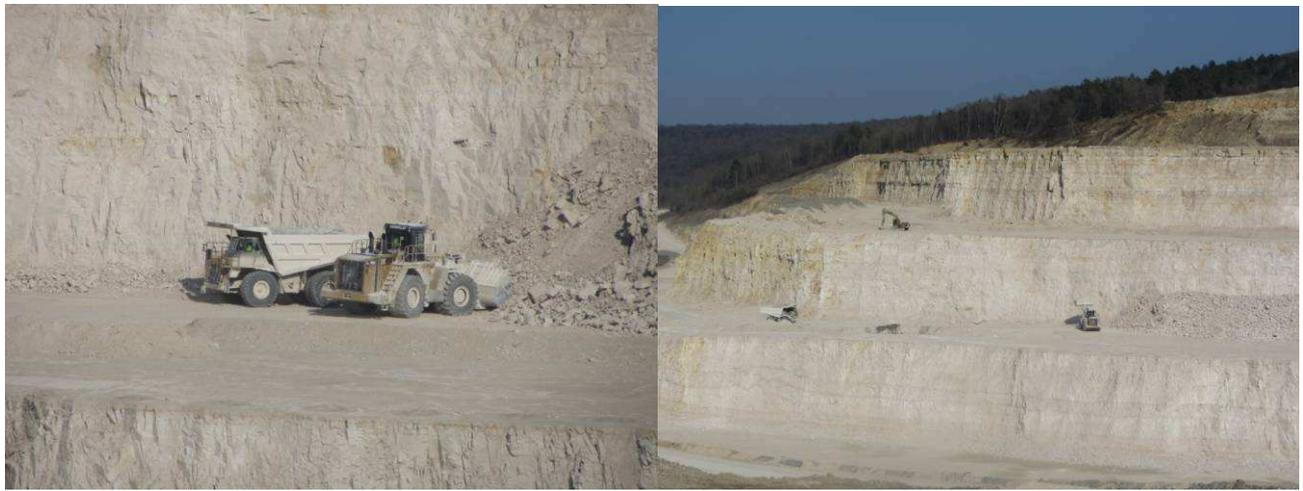
4000 tonnes de calcaires sont ainsi triées chaque jour, stockées dans une trémie ou à l'air libre, puis transportées par train à DOMBASLE sur Meurthe pour la fabrication du carbonate de soude (procédé Solvay) et à XEUILLEY par camions pour la fabrication du ciment à partir de marne et de calcaire.
